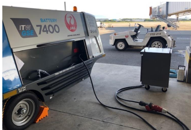
除雪車の車載ヒーター用電源の電源プラグを変換することで充電設備の設置が可能となった
