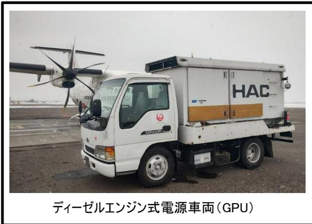
ディーゼルエンジン式電源車両 (GPU)
