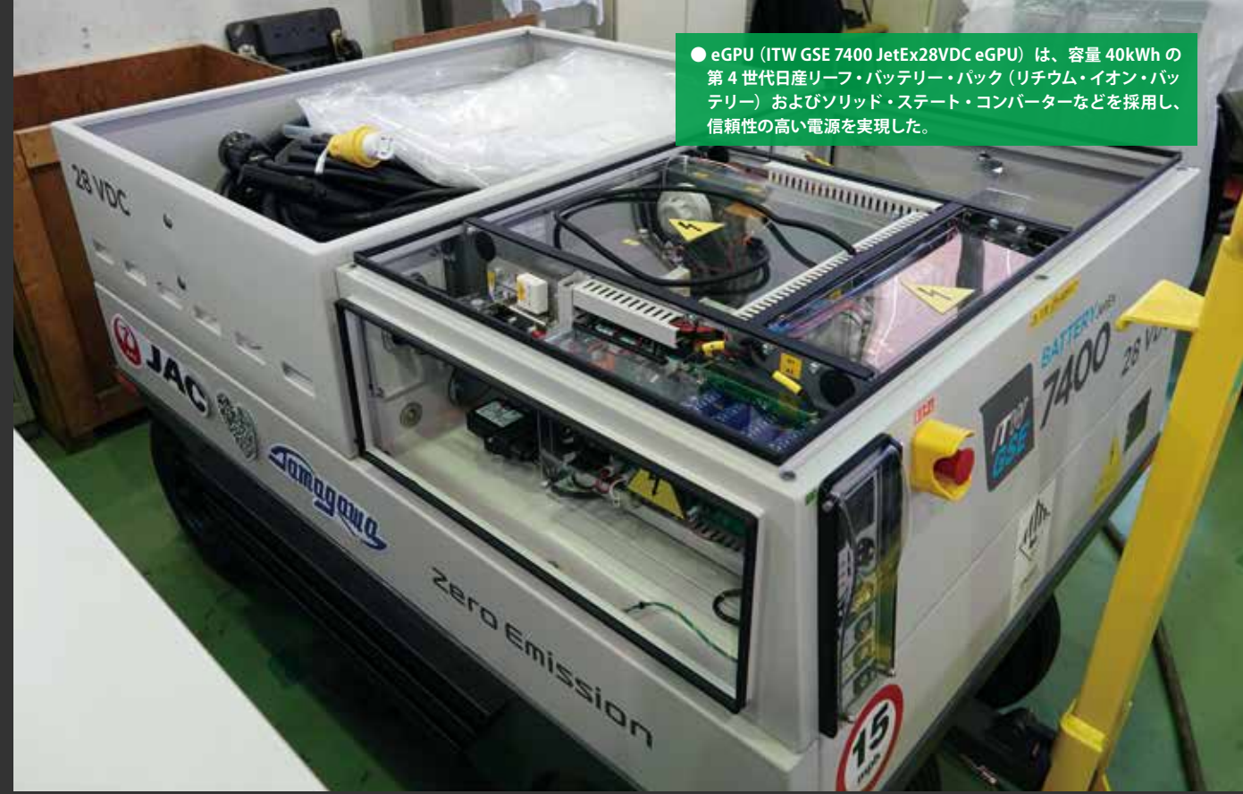
●eGPUの内部は、従来のGPUの様に内燃機関(ディーゼル・エンジン)駆動型発電機を排除し、燃料を燃焼して排気ガスを生じることが無く、低騒音のため、機体付近で作業する航空整備士やグラウンドハンドリング作業員にとって歓迎されるものとなっている。
