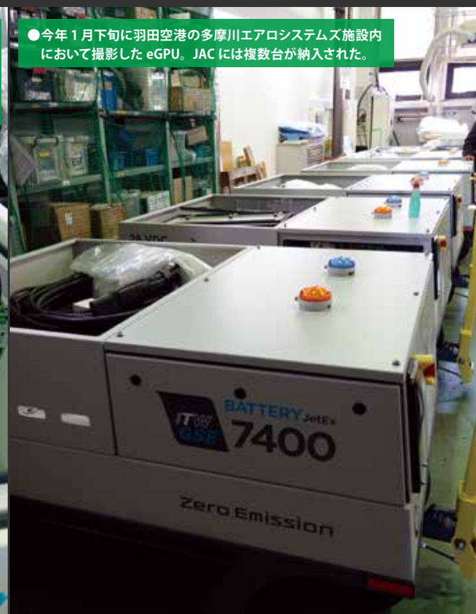
●eGPUの内部は、従来のGPUの様に内燃機関(ディーゼル・エンジン)駆動型発電機を排除し、燃料を燃焼して排気ガスを生じることが無く、低騒音のため、機体付近で作業する航空整備士やグラウンドハンドリング作業員にとって歓迎されるものとなっている。
