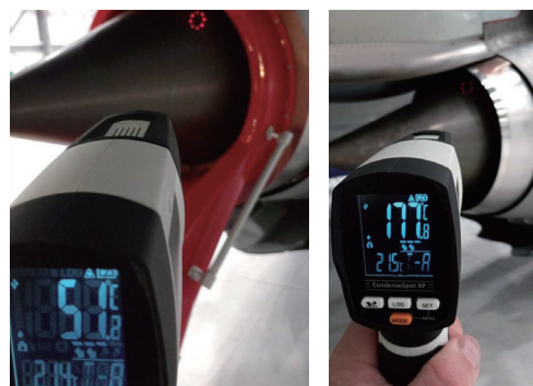
50分冷却後のエンジン表面温度差
